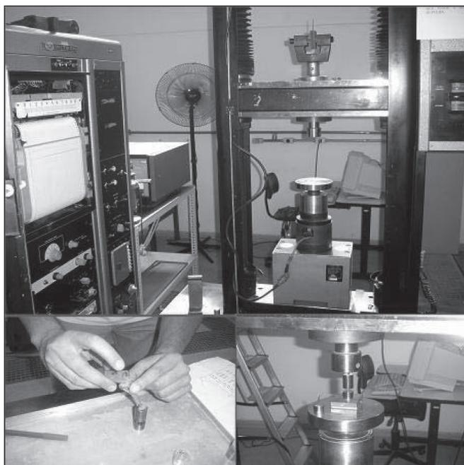
Figura 2 - Fabricação das pastilhas de cobre e amido de milho utilizando uma máquina para ensaios de tração e compressão.
