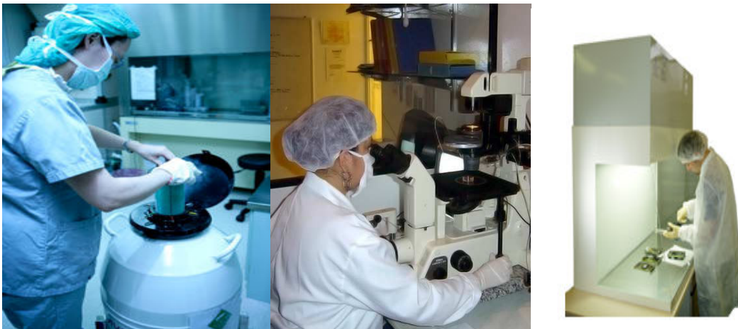
Figura 2- Contêiner para nitrogênio líquido, à esquerda, microscópio invertido, ao centro, Câmara de fluxo à direita, maquinários adequados para o uso em laboratórios de micromanipulação e criopreservação (reprodução humana)
